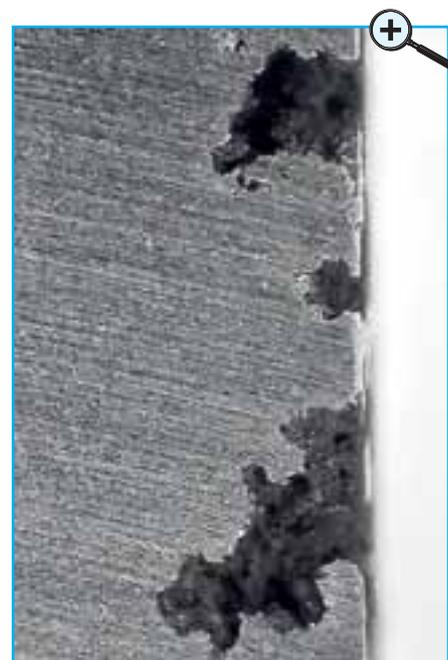
Abb. 3 Querschnitt der Zylinderlaufbuchse
