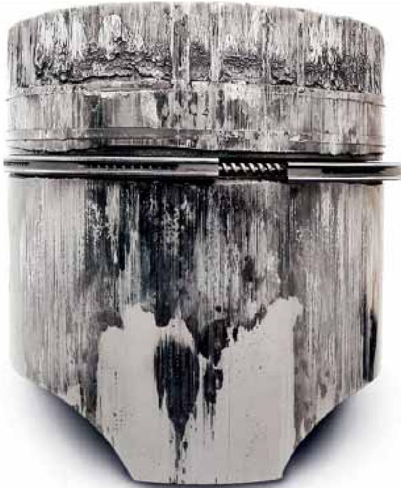
Beim Überhitzungsfresser bricht der Ölfilm infolge zu hoher Temperaturen zusammen. Es kommt zunächst zur Mischreibung und zu einzelnen Reibstellen. Im weiteren Verlauf kommt es durch die zusätzliche Aufheizung an den Reibstellen zum kompletten Trockenlauf des Kolbens im Zylinder. Die Fressstellen sind dunkel verfärbt und stark aufgerissen. Je nach Schadenursache beginnt der Überhitzungsfresser entweder am Kolbenschaft oder am Kolbenkopf.
